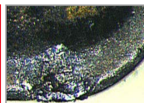
Inserto rivestito CVD convenzionale
